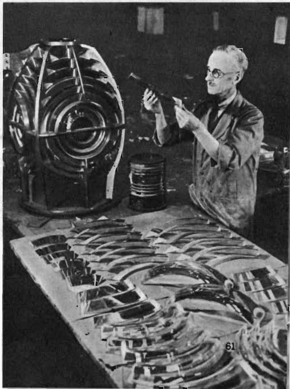
In alto a destra: La paziente verifica dei generatori elettrici ne assicura la lunghissima durata. Qui sopra: Il montaggio dei prismi è un lavoro delicatissimo. Qui si vede uno specialista che si serve, per controllo, di una piccola sorgente luminosa ed un mirino a punta. Qui a destra: le forme complesse che assumono le parti ottiche sono tali da raccogliere tutta l'intensità luminosa della sorgente, per concentrarla in un fascio orizzontale senza dispersioni.
