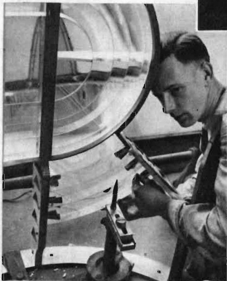
In alto a destra: La paziente verifica dei generatori elettrici ne assicura la lunghissima durata. Qui sopra: Il montaggio dei prismi è un lavoro delicatissimo. Qui si vede uno specialista che si serve, per controllo, di una piccola sorgente luminosa ed un mirino a punta. Qui a destra: le forme complesse che assumono le parti ottiche sono tali da raccogliere tutta l'intensità luminosa della sorgente, per concentrarla in un fascio orizzontale senza dispersioni.
