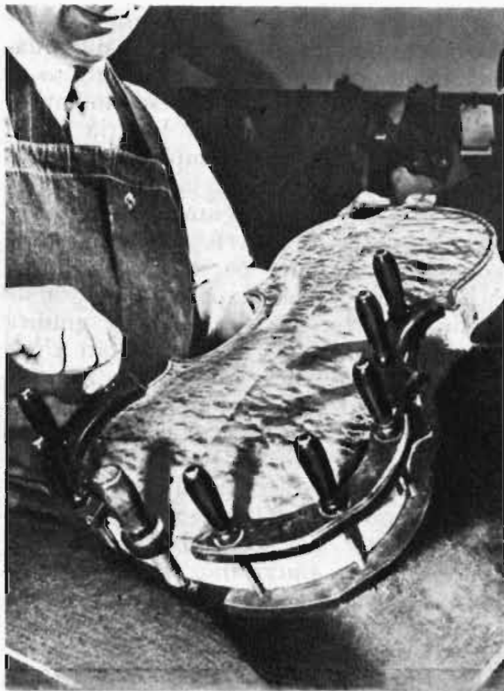
Sopra: La viola viene messa nella speciale pressa, che ha lo scopo di tenere unite le varie parti che sono state incollate.
